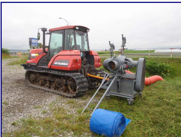
移動式排水ポンプ
